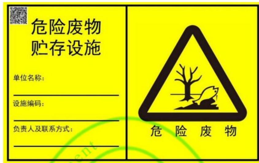
危险废物暂存间外标识
