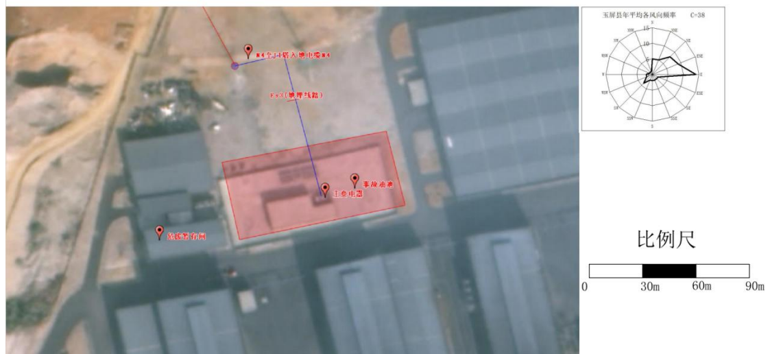
附图4-2 项目降压站平面布置图（补充事故油池、主变压器、危废暂存间位置）
