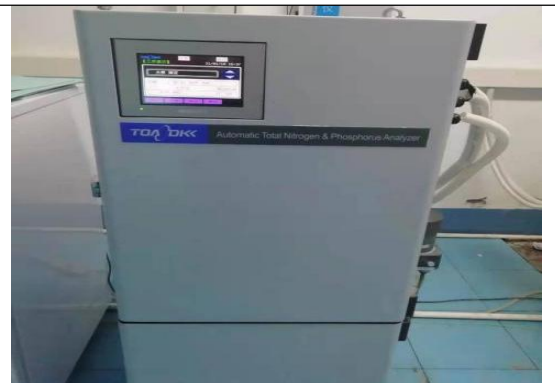
进水口总磷总氮在线检测仪
