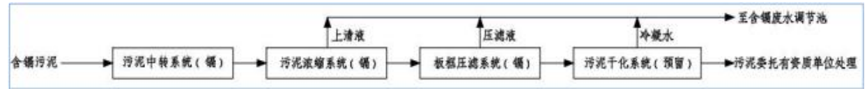
图 7.2.2-19 含镉污泥处理工艺流程图
