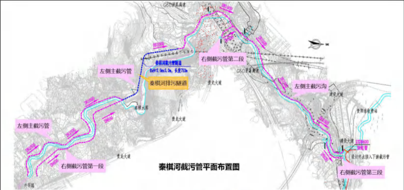
图 4.3 秦棋河截污管平面布置图
