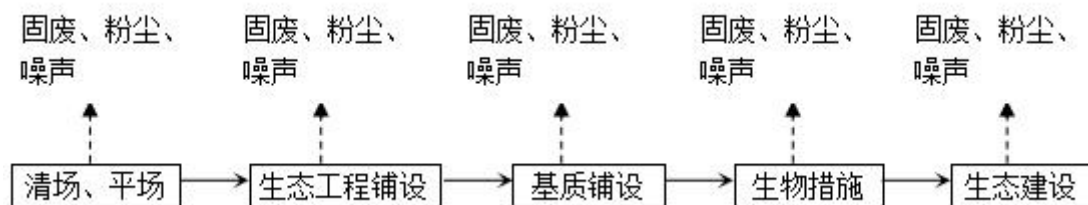
图 4-3 景观工程、河道生态修复工程施工工艺及产排污节点图
