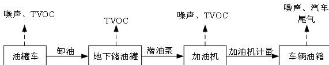
图 2-6 柴油加油工艺流程图
