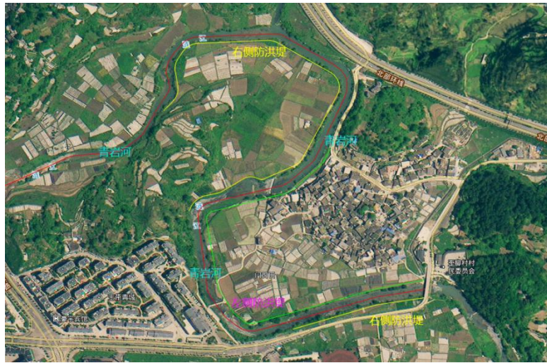
图 2.5-2 青岩河防洪堤示意图
